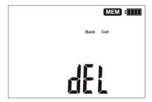
...die Nummer der Datenbank verschwindet, und es erscheint das Symbol dEL, das die Bereitschaft zum Löschvorgang signalisiert.
